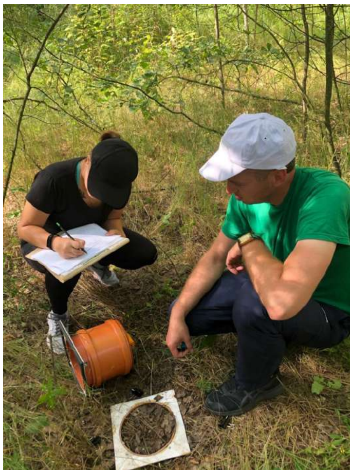
Рис. 15.43. Оценка почвенной эмиссии CO 2 методом закрытых камер
